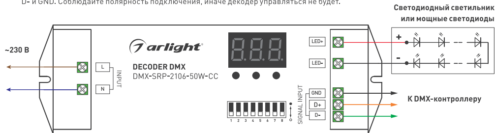
Рисунок 2. Схема подключения декодера.
